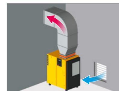
Fig. 4 : Ventilation forcée avec une gaine d'évacuation d'air chaud pour les centrales à partir de 11 kW
